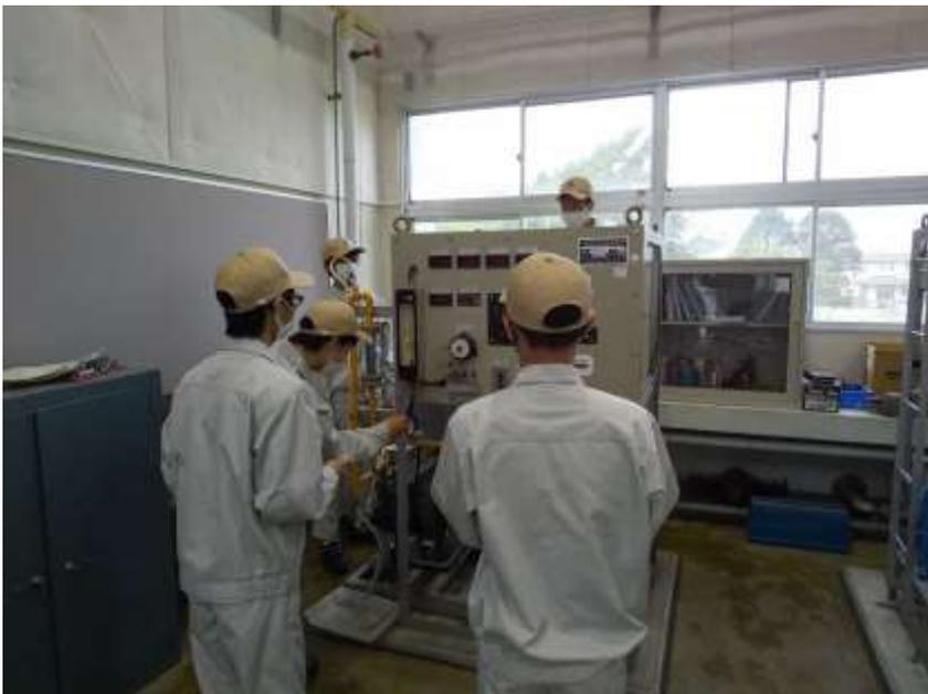
写真はディーゼルエンジンの性能試験を行っている様子です。
