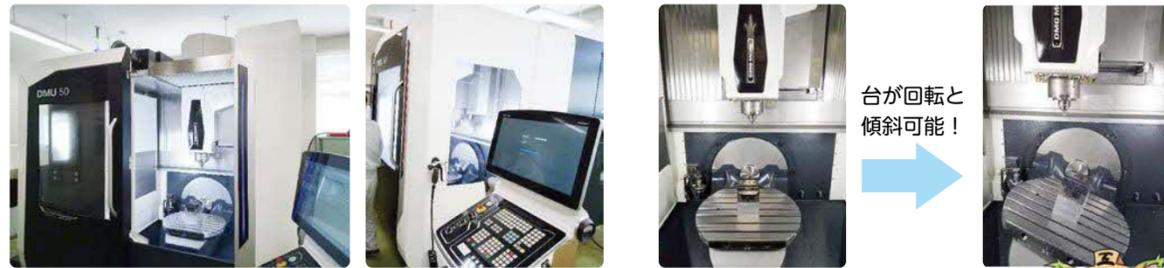
内部に吊り下げられた主軸の先端に取り付けられた工具が回転をしながら、上下、左右、前後に動き、同時に材料が取り付けられた台が回転と傾斜をすることで相対的に5軸の動きが実現され、複雑な形状を持つものも加工が出来ます。実習、その他でも積極的に活用していきます。
