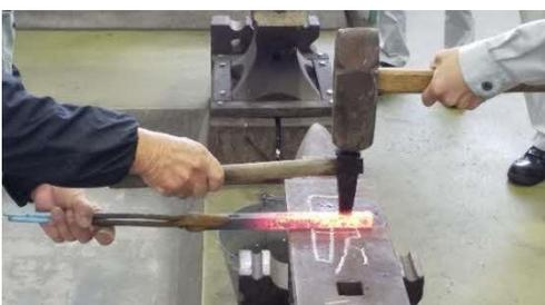
鉄は温度によって結晶構造が変化します。左の写真の鉄は密度が一番高い状態であり、変形させやすい状態です。約1200℃ですが、工具を用いてハンマーの頭の部分を成形しています。一見、容易に見えますが、すごいことを体験しています！体験でしか学べないこと、それが技能です。機械科では技能を学べます。
