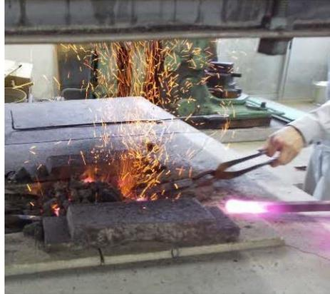
鉄はとても硬いため、加工するためにはコークス（石炭を加工した燃料）を用いて加熱します。左の写真の右下に加熱した鋼材が映っていますが、この色がとても重要で、加工温度の目安となります。
